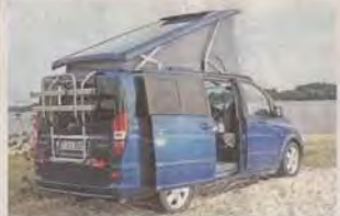
Le Mercedes Marco Polo comporte un toit montant qui se mue en lit. DR
